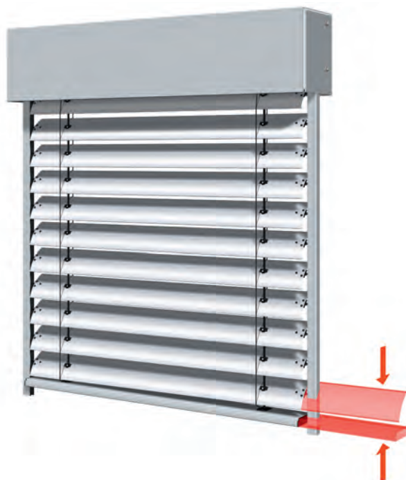
Bild 6: Lage der Unterschiene im abgefahrenen Zustand
